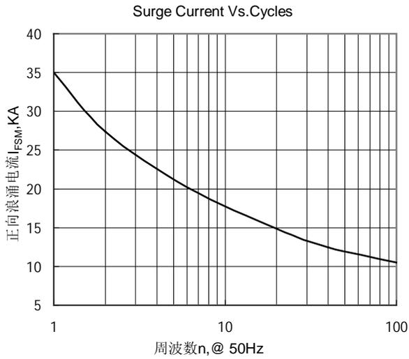
Fig.7 正向浪涌电流与周波数的关系曲线
