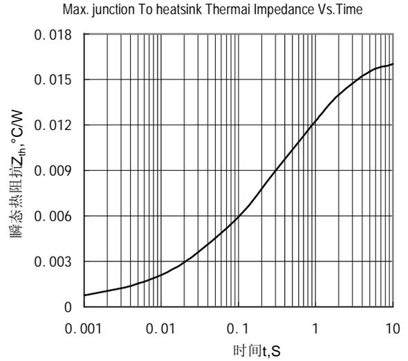
Fig.2 结至散热器瞬态热阻抗曲线
