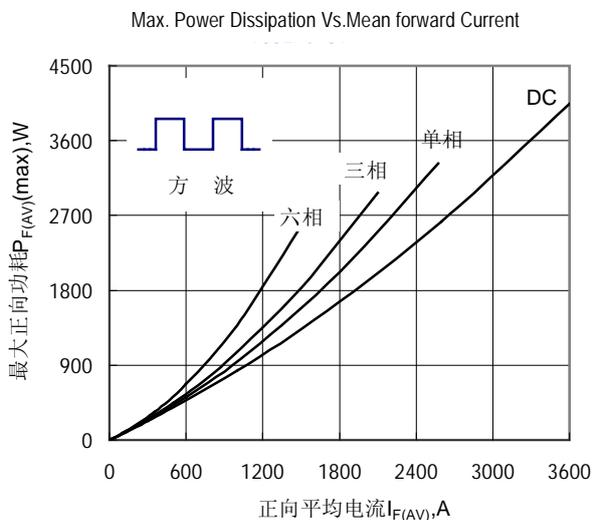
Fig.5 最大功耗与正向平均电流关系曲线
