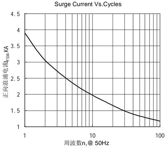
Fig.7 正向浪涌电流与周波数的关系曲线
