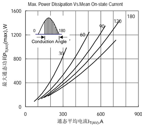
Fig.3 最大功耗与平均电流关系曲线
