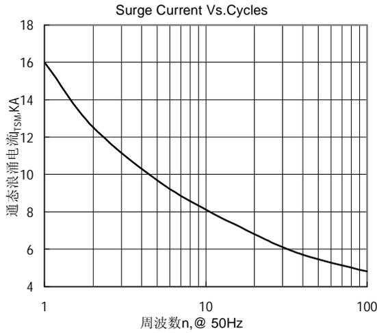
Fig.7 通态浪涌电流与周波数的关系曲线
