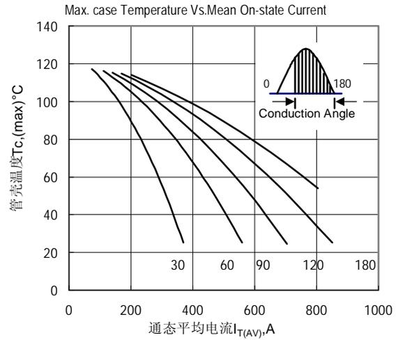
Fig.4 管壳温度与通态平均电流关系曲线
