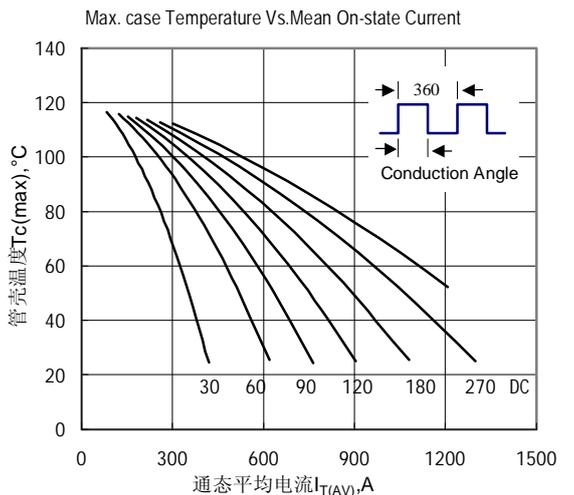
Fig.6 管壳温度与通态平均电流关系曲线
