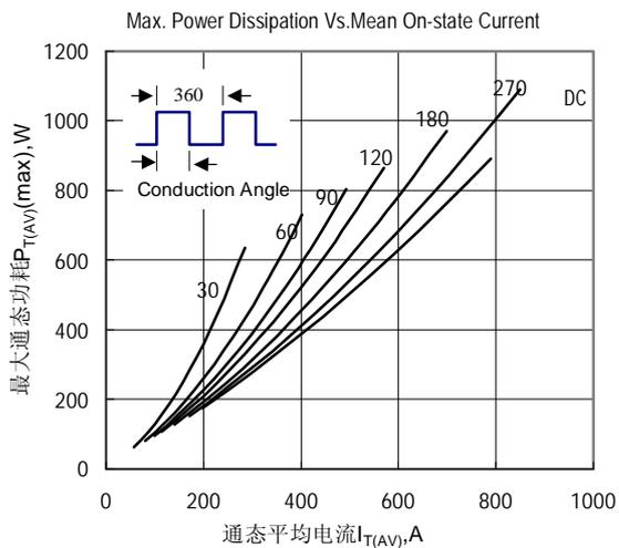
Fig.5 最大功耗与平均电流关系曲线
